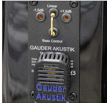
Oben die Bassanpassung, darunter das für unseren Hörraum perfekte „Bass Extension“-Modul.
