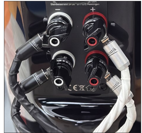
Das WBT-Bi-Wiring-Terminal hat neue Flügel-schrauben und ermöglicht hohen Anpressdruck.
