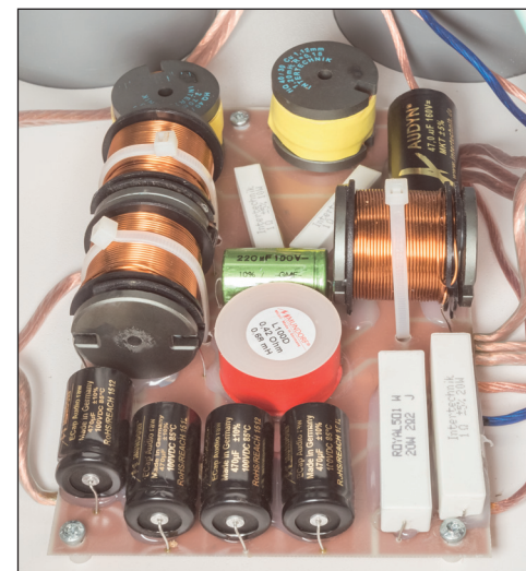
Das Ergebnis immensen Rechenaufwandes: die symmetrische Frequenzweiche mit rekordverdächtiger Filtersteilheit
