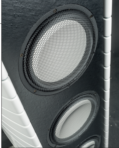
Drei Neunzoll-Tieftöner sorgen für das äußerst beeindruckende Fundament der RC8
