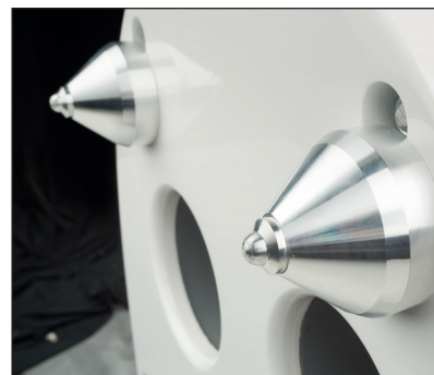
Spikes entkoppeln die 85 Kilogramm schwere Box vom Boden, ihre Höhe hat Einfluss auf die Basswiedergabe
